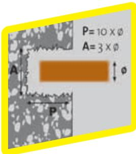
Realizar la regata del anclaje. Limpiar y eliminar el polvo. Verificar que la profundidad y el ancho sean correctos con respecto al diámetro del anclaje.
