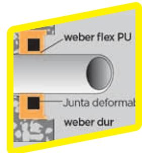
Colocar una junta estanca alrededor del tubo y sellarla con weber flex PU deformable. Rellenar con weber dur.
