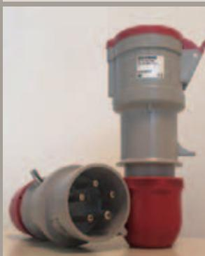
Conexión de cable de 5 conductos por 4 mm. de sección hasta 30 metros de longitud. Pasada esa distancia aumentá 1 mm. de sección cada 10 metros.
