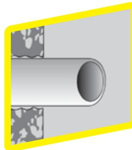
Perforar la pared (ligeramente superior al diámetro del tubo por colocar). Descarnar los bordes formando una abertura de 1x4 cm. Eliminar el polvo y limpiar. Colocar el tubo.
